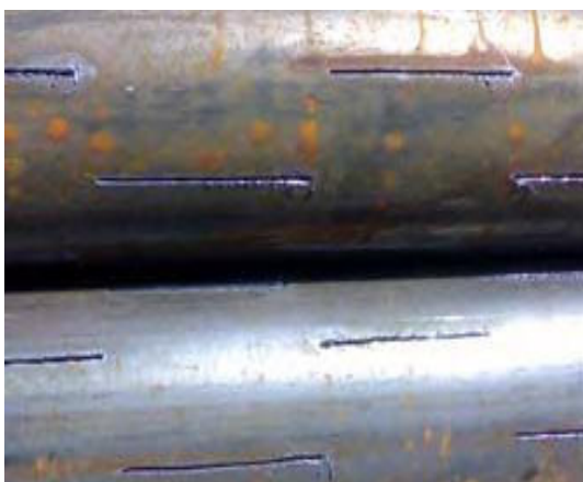
شکل ۴- لوله های جدار که به کمک شعله گاز استیلن در محل حفاری شکاف دار می گردند. و بعنوان لوله اسکرین استفاده می شوند.
