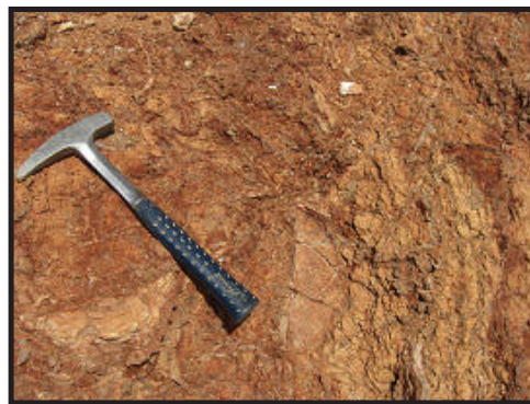
شکل ۸- تشکیل ژپس بدلیل پدیده لیچینگ
