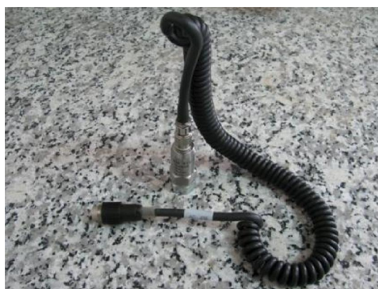
شکل ۲: حسگر شتاب سنج پیزوالکترونیک و کابل
