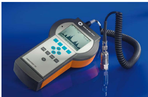
شکل ۳: نمایی از شتاب سنج، کابل و دستگاه ارتعاش سنج VT60
