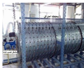
شکل (۲): کوره و مشعل نصب شده روی آن ب: طرحواره سطح مقطع ورودی هوا به مشعل
