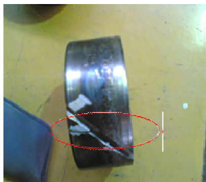
شکل (۸) ایجاد ترک در رینگ بیرینگ دمنده واقع
