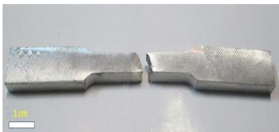
شکل (۱۱): نمونه آزمون کشش شکسته شده از ناحیه اغتشاشی
