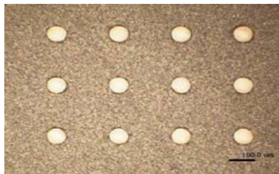
شکل ۲. ویفر سیلیکونی با ضخامت 200\ (\mu\text{m}) با سوراخ‌هایی به قطر 50\text{--}60\ (\mu\text{m}) سوراخ شده‌اند [۲۸].
