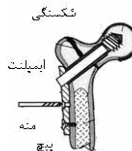
شکل (۱): کاربرد سوراخکاری در ثابت‌سازی استخوان شکسته [۳]
