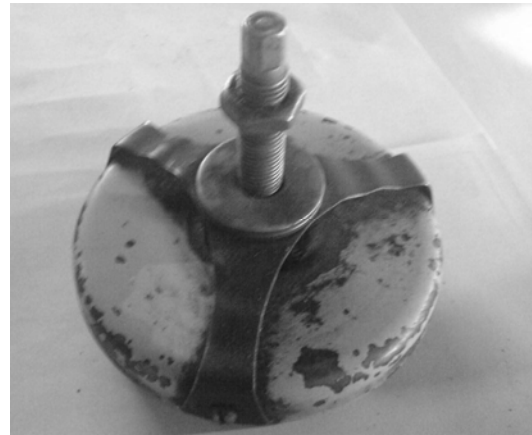
شکل (۵): نمونه‌ای از جاذب‌ها که در پایه دستگاه نصب می‌شوند
