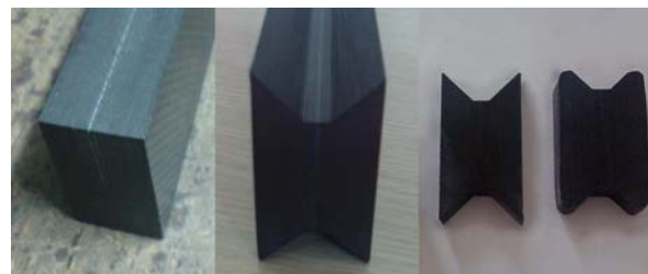
شکل (۴): مراحل تولید نمونه تراشکاری شده از قطعه اولیه
