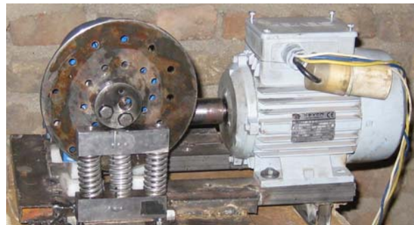
شکل (۱): دستگاه تستر فنر و فیکسچر مربوطه
