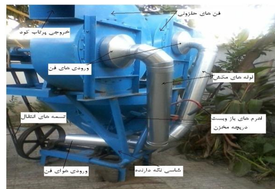
شکل (۶): دستگاه کودپاش بادی ساخته شده
