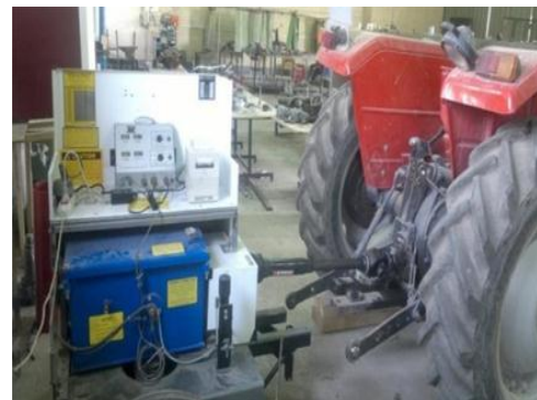
شکل (۲) دینامومتر متصل به تراکتور مورد استفاده در آزمایش (MF 240)
