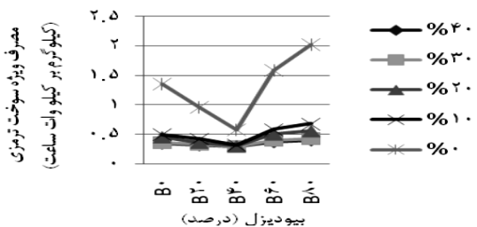
شکل (۱۰) اثرگذاری سوخت بیودیزل بر مصرف ویژه سوخت ترمزی در بارهای مختلف و دور ثابت ۱۳۴۰ دور بر دقیقه
