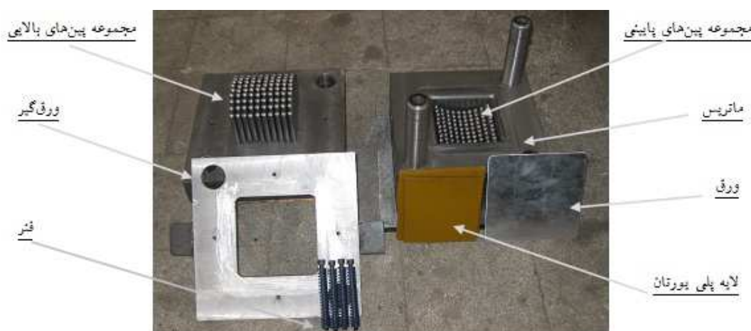
شکل (۴): مجموعه قالب شکل دهی چند نقطه‌ای ساخته شده جهت انجام آزمایشات تجربی.
