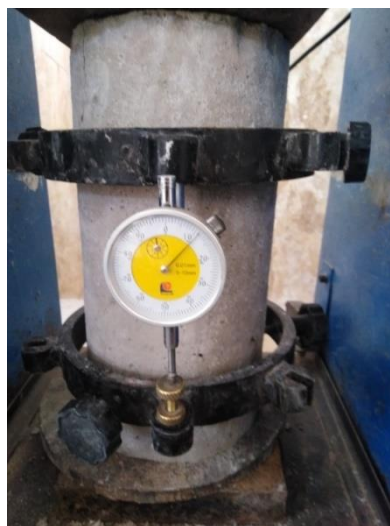
شکل ۴- نمونه بتنی در حال انجام آزمون مدول الاستیسیته بتن
