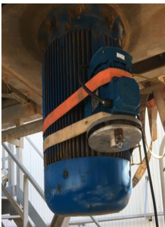
شکل ۱۰: چگونگی اتصال موتورالکتریکی با جرم نامیزان به الکتروموتور فن
