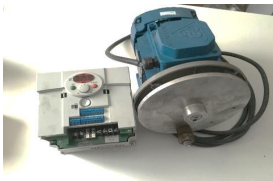
شکل ۹: موتور الکتریکی به همراه جرم نامیزان و دستگاه کنترل دور
