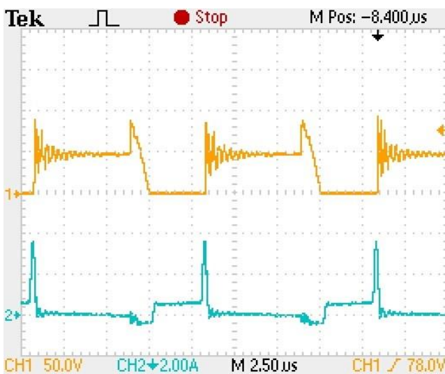
شکل (۱۹): موج ولتاژ و جریان یکسو کننده V_{D0}, I_{D0}
