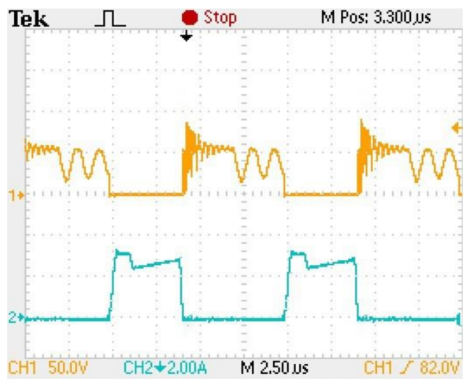
شکل (۱۸): موج جریان و ولتاژ سوئیچ V_s, I_s
