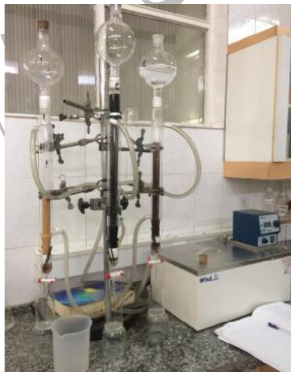
شکل ۱- ستون های رزینی جهت جداسازی بتائین از ملاس با دستگاه حمام آبی با قابلیت کنترل درجه حرارت در سطح آزمایشگاهی
