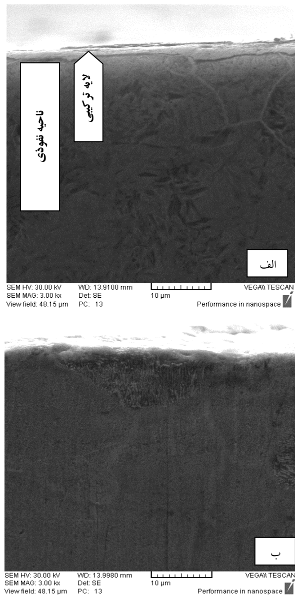
شکل (۳): تصاویر SEM نمونه آئیل شده پس از نیتروژن دهی در دمای
