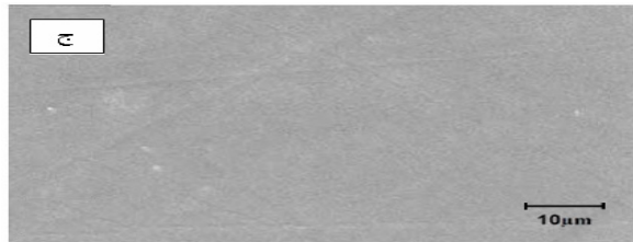
شکل (۴): توزیع کاربیدها در فولاد زنگ‌نزن AISI 420 در دماهای آستنیت‌دهی (الف) ۱۰۰۰، (ب) ۱۱۰۰ و (ج) ۱۲۰۰ °C (محلول اچ ماراکامی).
