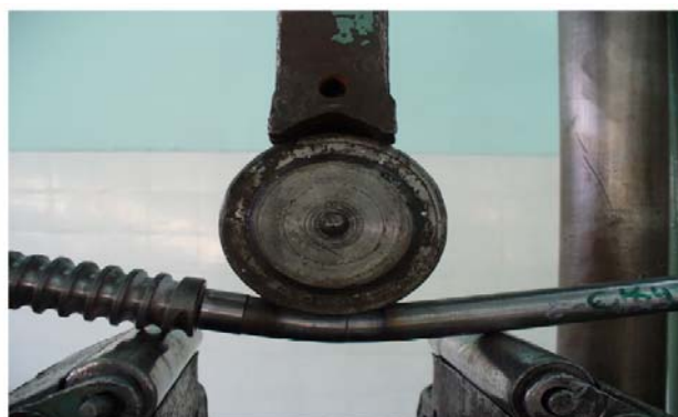
شکل (۱): نحوه انجام آزمون خمش
