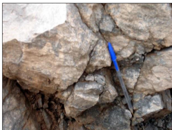
شکل ۱۰- ایستگاه درزه‌نگاری ۵ در توف‌های اسیدی واحد
