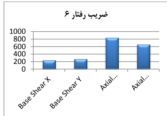
شکل ۷- خلاصه نتایج ساختمان ۳ طبقه با ضریب رفتار ۶
