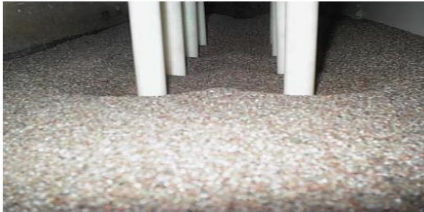
شکل ۲- حفره آبشستگی ایجاد در اطراف گروه پایه ( D = 2/2 \text{ cm} و h = 4/7 \text{ cm} ، G = 2D )
