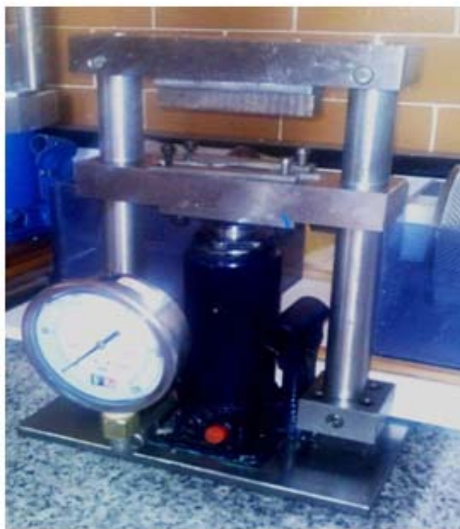
تصویر ۹- شمای کلی از دستگاه پانچ بلوکی استفاده شده برای این تحقیق
